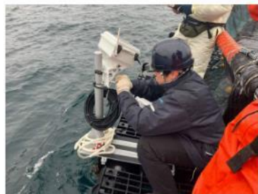
(波高計の導入による海況のリアルタイム把握、作業可否判断の正確性向上に繋げる)
