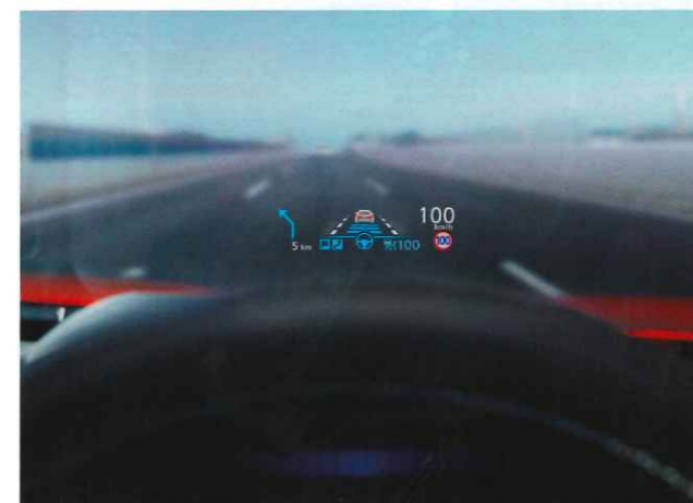
プロパイロット 2.0の運転情報を投影するカラーヘッドアップディスプレイ
